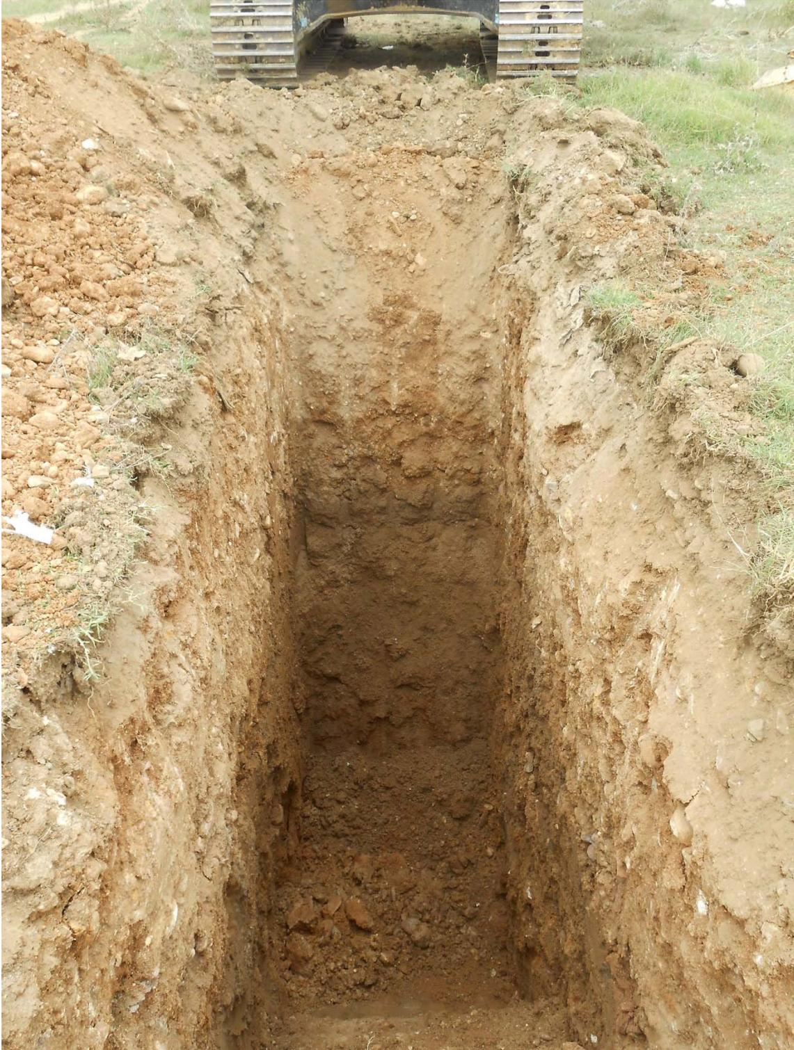
Fig. 9: Pozzetto stratigrafico P3 (-5.00 p.d.c.)
