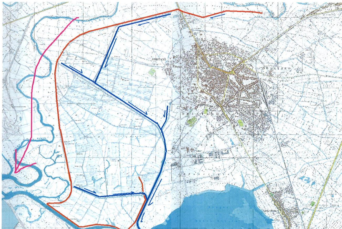
**L'area complessiva vista nella carta del 1974, con l'argine in sinistra Tirsu in arancione, la direzione di deflusso del Tirsu in viola e i canali drenanti principali e la direzione del deflusso delle acque drenate. Nel**
