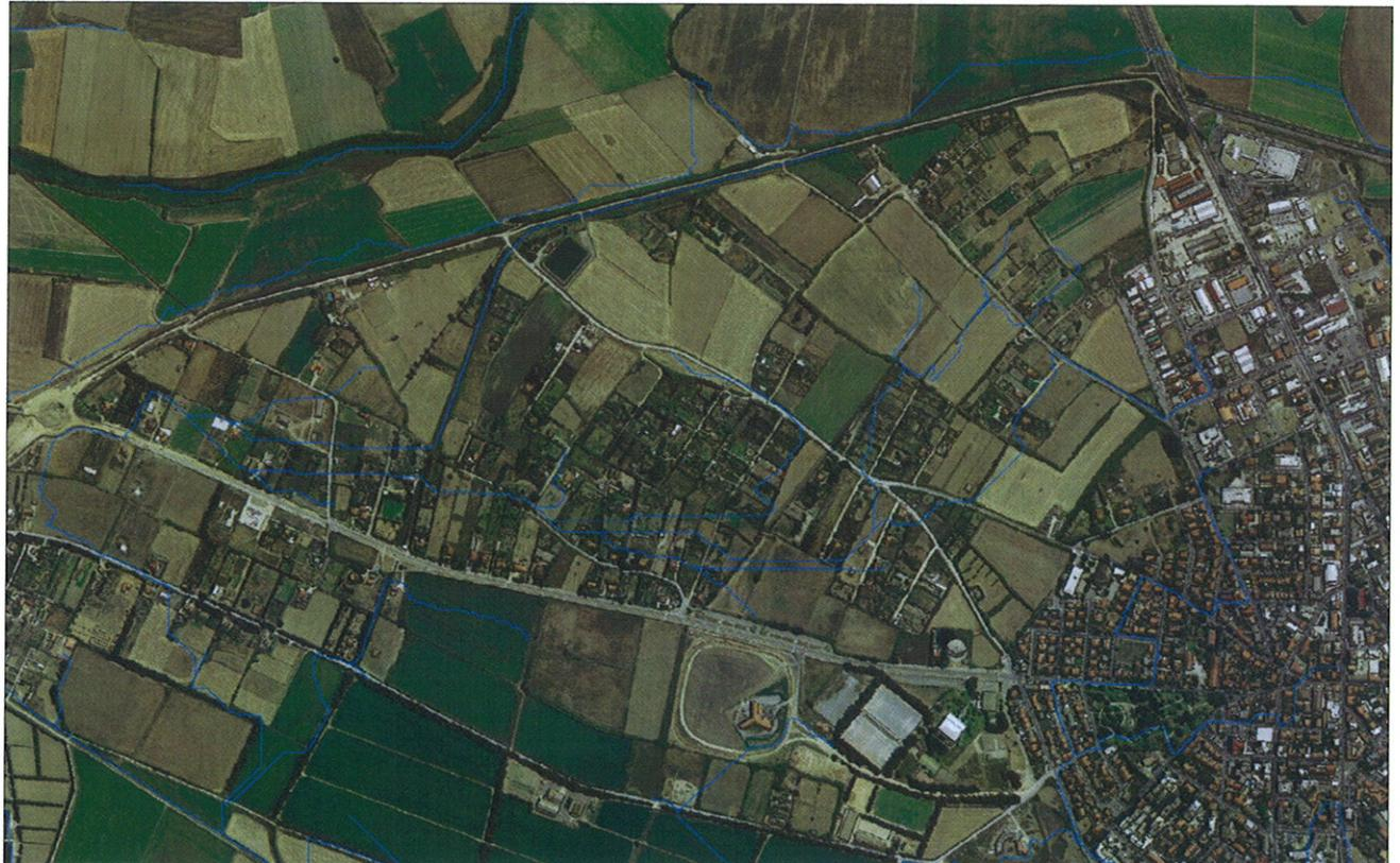
*Immagine dell'area con sovrapposto il sistema della concentrazione delle acque superficiali in funzione della sola pendenza (Flow-accumulation)*
