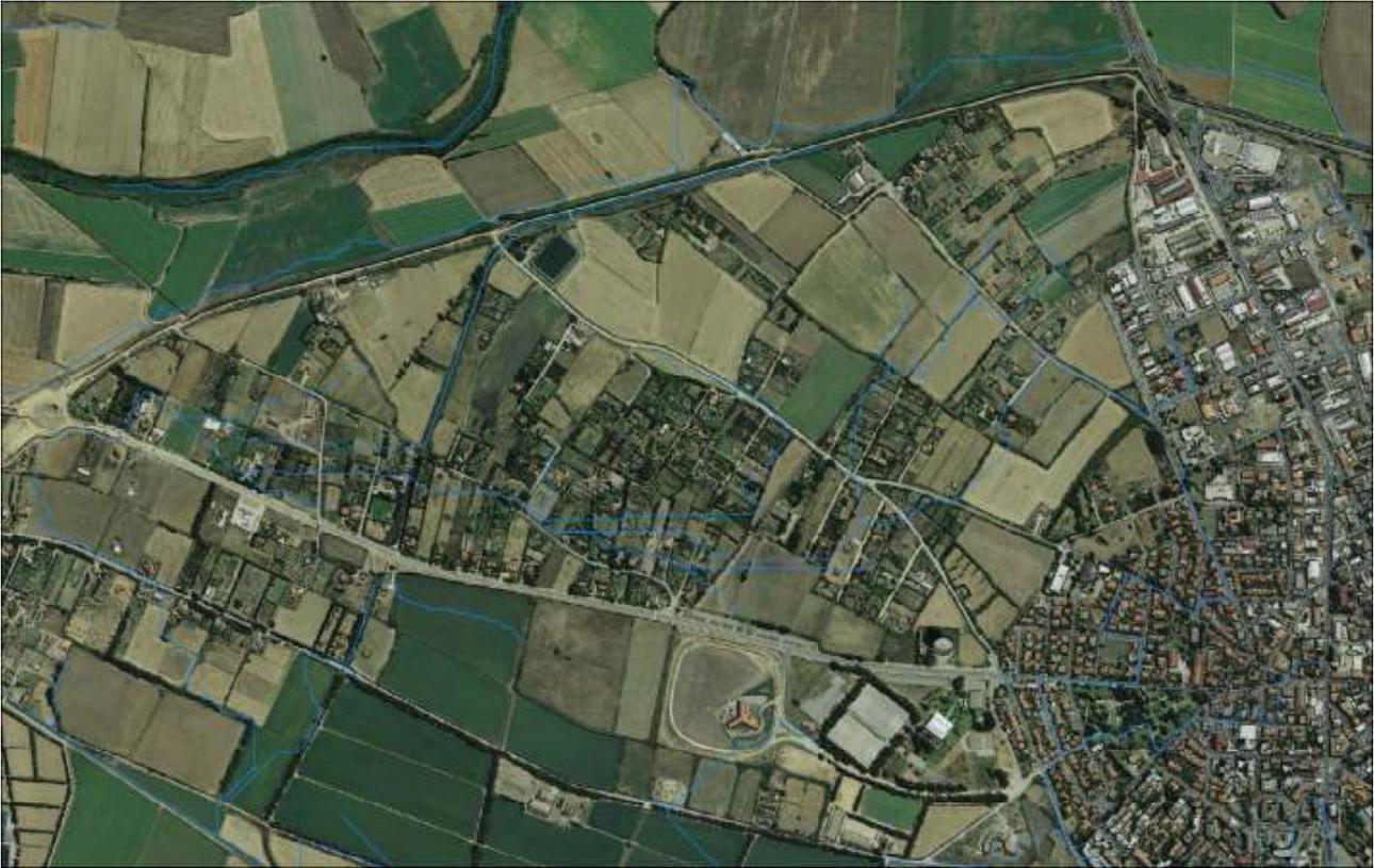
*Immagine dell'area con sovrapposto il sistema della concentrazione delle acque superficiali in funzione della sola pendenza (Flow-accumulation)*
