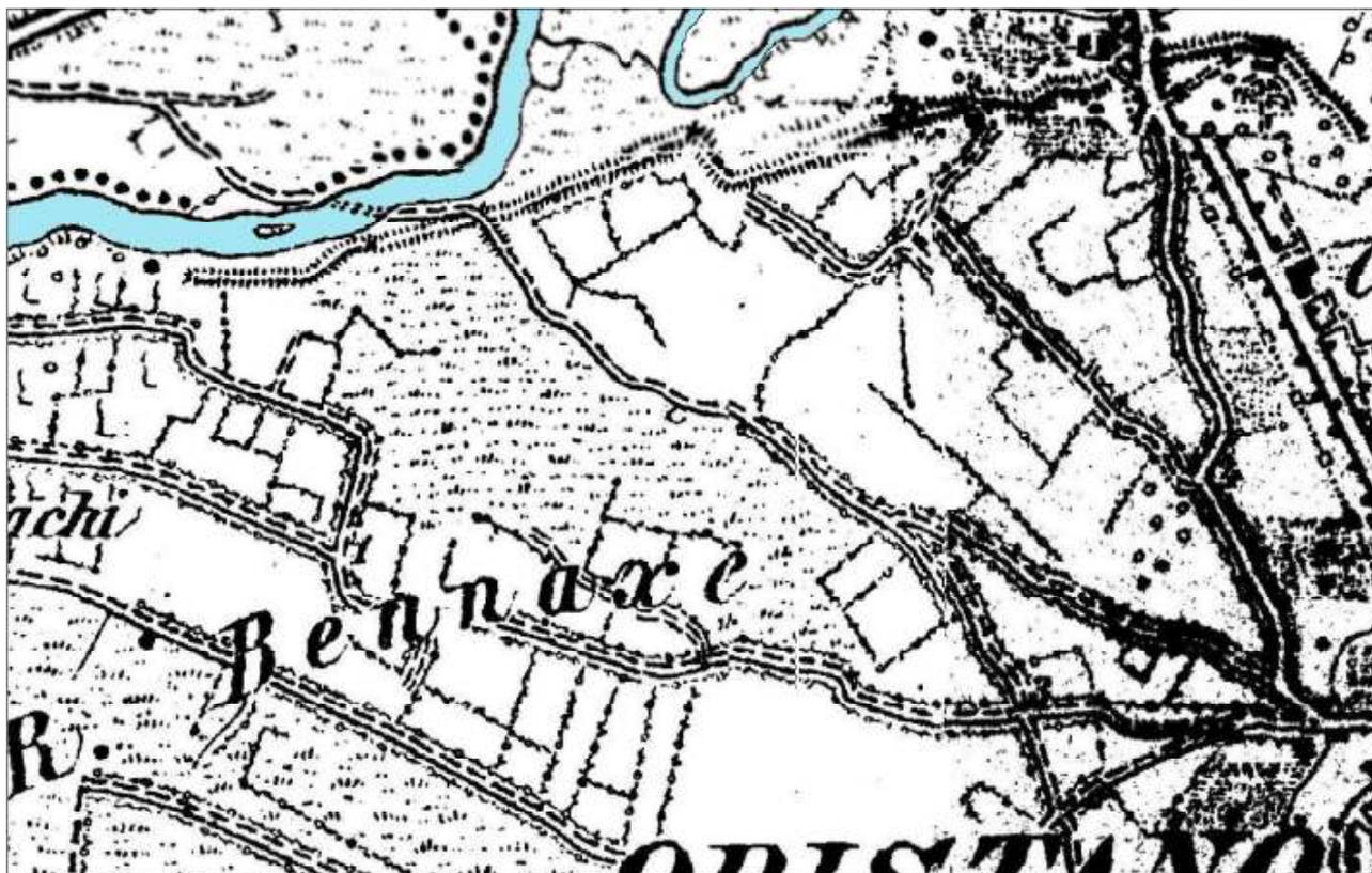
*L'area in esame nella carta IGM 1898 con l'evidenza del primo lembo di argine e l'assenza di un sistema idrografia naturale drenante*
