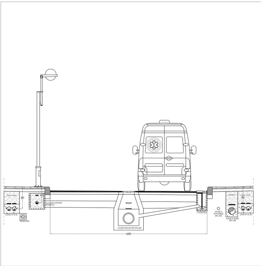
TIPOLOGIA DI SEZIONE STRADALE INTERNA Scala 1:100
