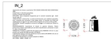
PIANTA SEZIONE - IN2 scala 1:20
